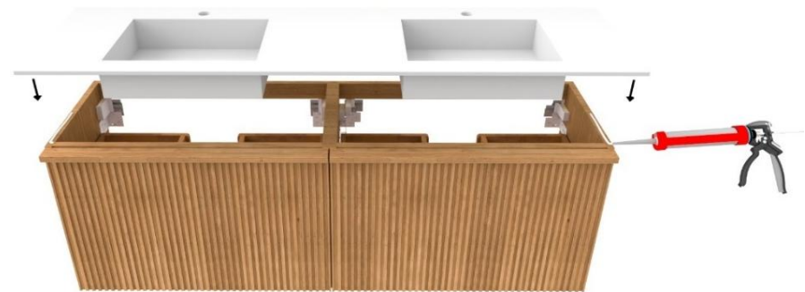
4. Waschbecken auf dem Möbel mit Dichtstoff fixieren
